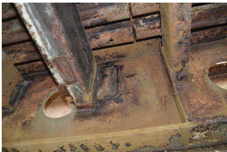
Odpálený původní podélník, nahrazen válcovaným profilem
